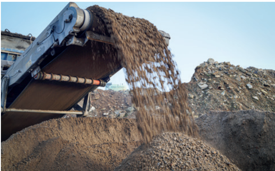
Mellemd Depot for betonelementer inden nedknusning til genanvendelse. Større fremmedelementer fjernes og ved selve nedknusningen blæses lette elementer væk, imens jern fjernes med magnet.
