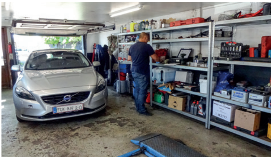
På dette autoværksted er gulvet tæt og uden afløb, så hele lokalet betragtes som en spildbakke.
