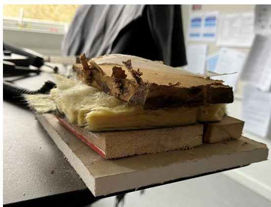
Billede 2, viser konstruktionsopbygning i ydervæg.
