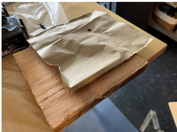
Billede 13, gulvplade og fugtspærre.
